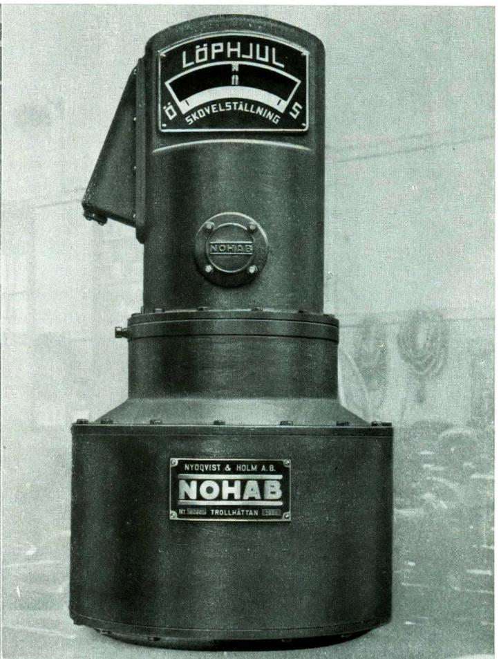
Servomotor que regula las paletas del rotor
