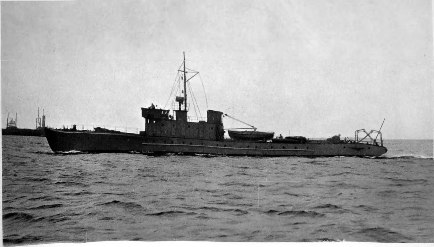
Dragaminas polaco equipado con 2 motores Diesel NOHAB, cada uno de 520 HP.
