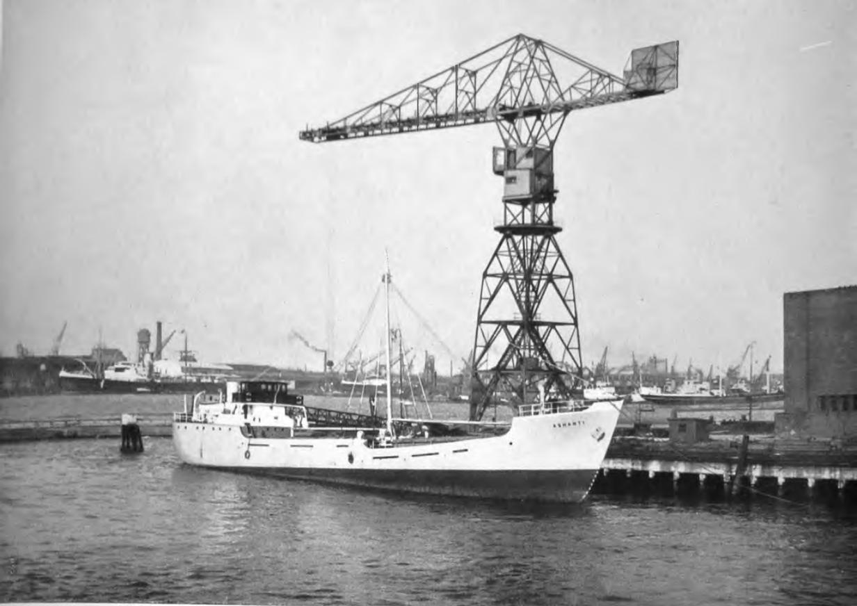
Barco tanque británico "ASHANTI" de la casa T. E. Evans & Co., Ltd., Londres. La maquinaria propulsora comprende un motor Diesel NOHAB de 6 cilindros, tipo MG-6, de 400 HP a 335 r. p. m.
