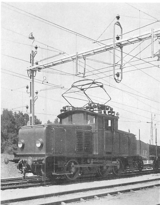
Elektrolok litt Ub. Användes i växlingstjänst. Hkr totalt 830. Vikt 47.1 ton. Maximal dragkraft 16 ton. Maximal hastighet 45 km/tim.
