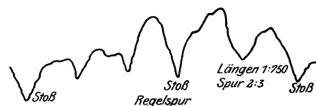
Abb. 2. Krumme, nach außen gebogene Schienen.
