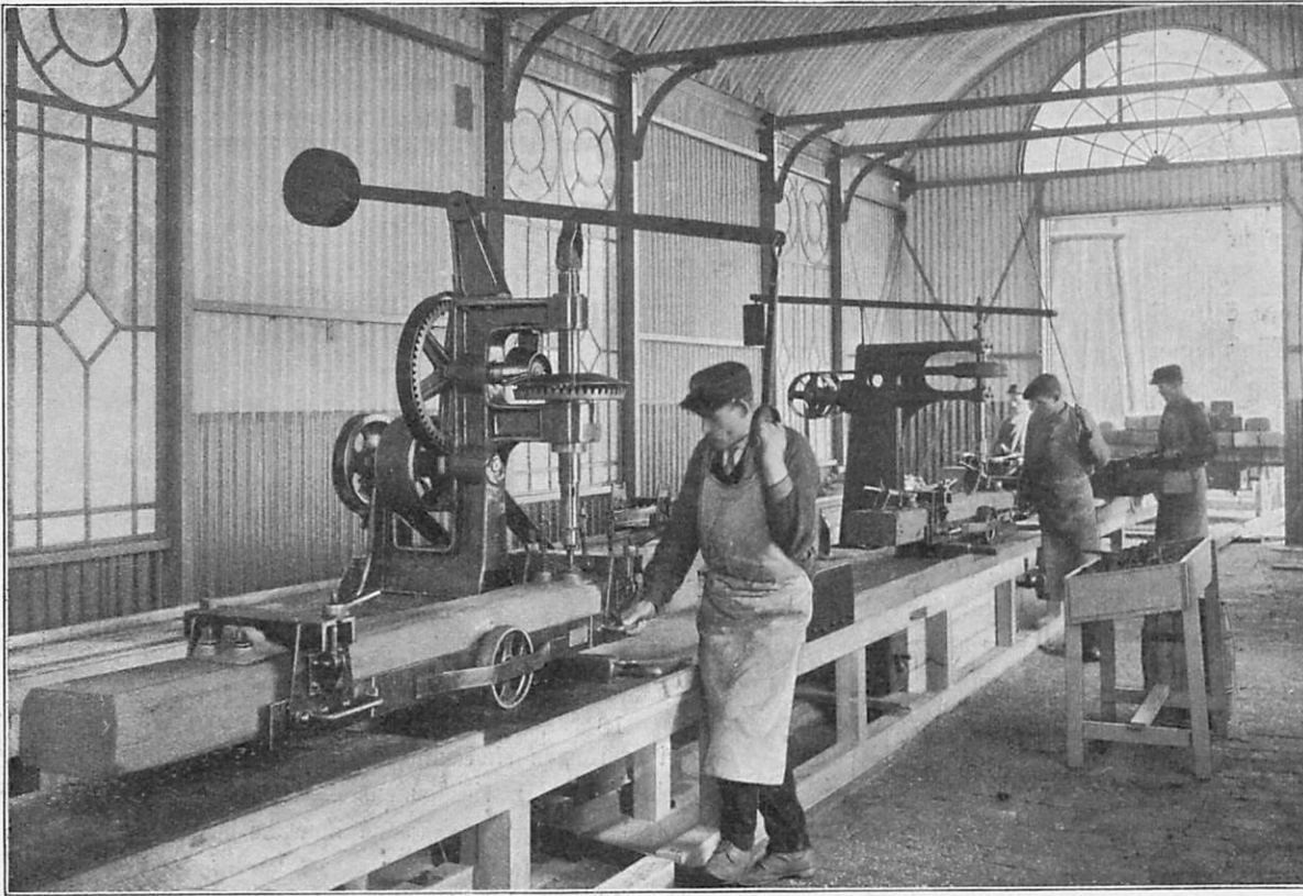
Abb. 2. Werkstätte der Niederländischen Zentral-Eisenbahn-Gesellschaft in de Bilt bei Utrecht, in der die Stühle auf die Schwellen geschraubt werden.
