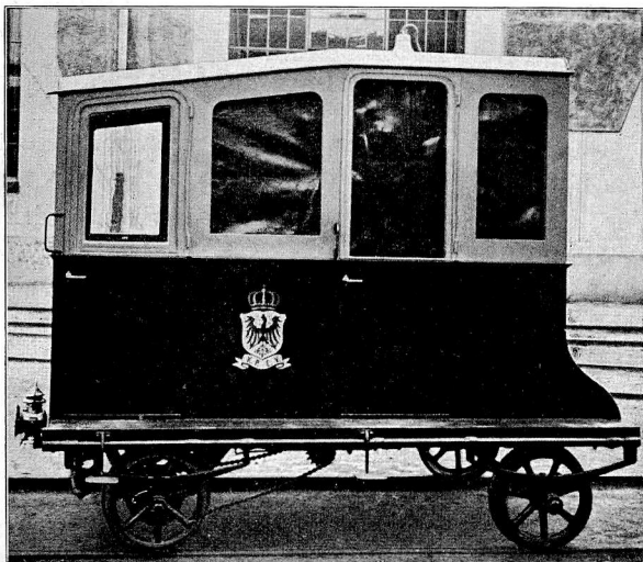
Abb. 2. Triebkleinwagen mit 7 PS-Triebmaschine und Umbau.
