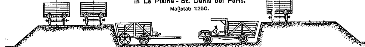
Abb. 7. Anlage von Lagerplätzen ohne doppeltes Umladen. Maßstab 1:250.
