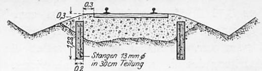
Abb. 6 und 7. Entwässerung weicher Dämme. Maßstab 1:176.
