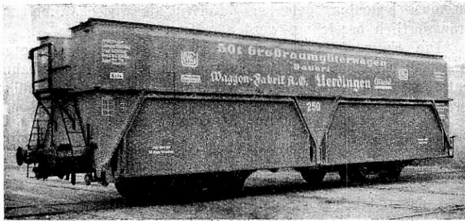
Abb. 3. 50 t-Großgüterwagen (Sattelwagen-Selbstentlader) Bauart Uerdingen. Ansicht von oben.
