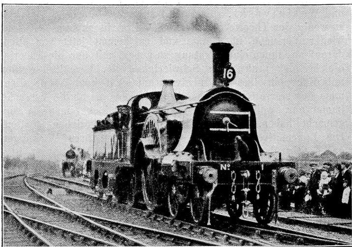
Abb. 4. Schnellzuglokomotive mit Einzeltriebachse im Festzug; gebaut 1872 für die Great Northern-Bahn.
