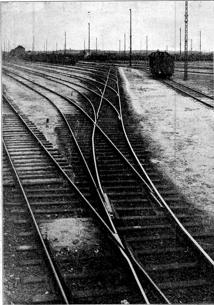
Abb. 2. Auslaufweiche mit festen Zungen. Bei der vordersten Weiche ist gezeigt, wie durch Einlegen eines Stahlkeiles die Weiche gegen die Spitze befahrbar gemacht werden kann.
