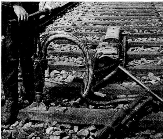
Abb. 1. Zum Stampfen umgebaute Kruppsche Gleisstopfmaschine.
