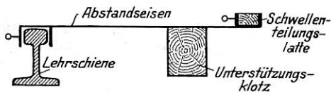
Abb. 8. Abstandseisen bei Gleisverschwenkungen.
