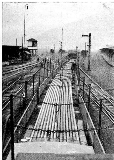
Abb. 5. 60 m lange Schienensendung bei der Ausfahrt aus Selztal.
