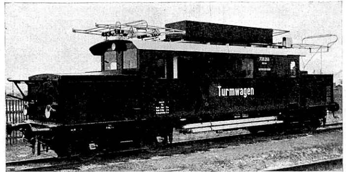
Abb. 33. Selbstfahrender Turmwagen mit Gleichstromantrieb für Gleichrichter und Speicherbetrieb.
