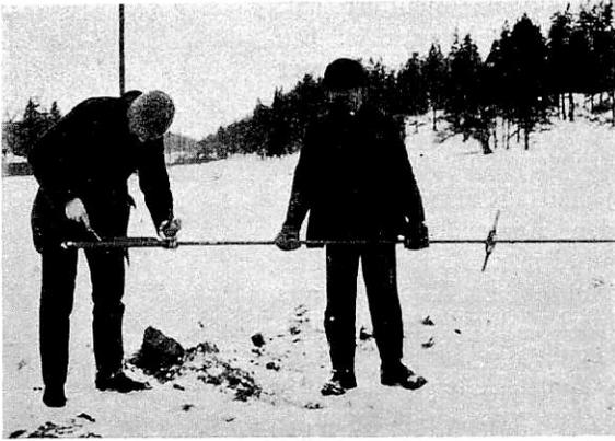
Abb. 4b. Der Zylinderbohrer wird seines Inhaltes entleert. In der linken Hand hat der Arbeiter ein Glas mit Salzsäurelösung. Mit ein paar Tropfen stellt er fest, ob der Boden kalkhaltig ist.
