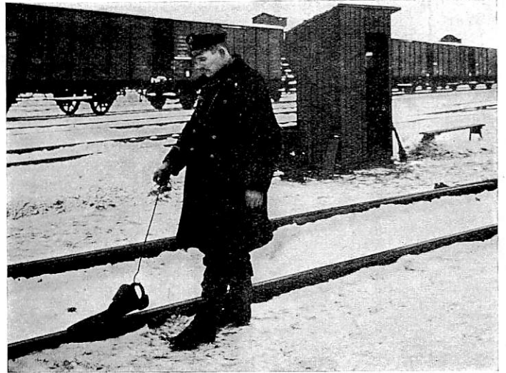
Abb. 13. Handbediente Hemmschuhbremse. Der Bremswärter legt den Hemmschuh mit dem Drahtthaken auf.
