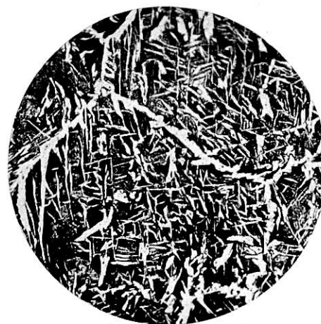
Abb. 13. Widmannstätten-Struktur. Ätzung II, \times 50 .
