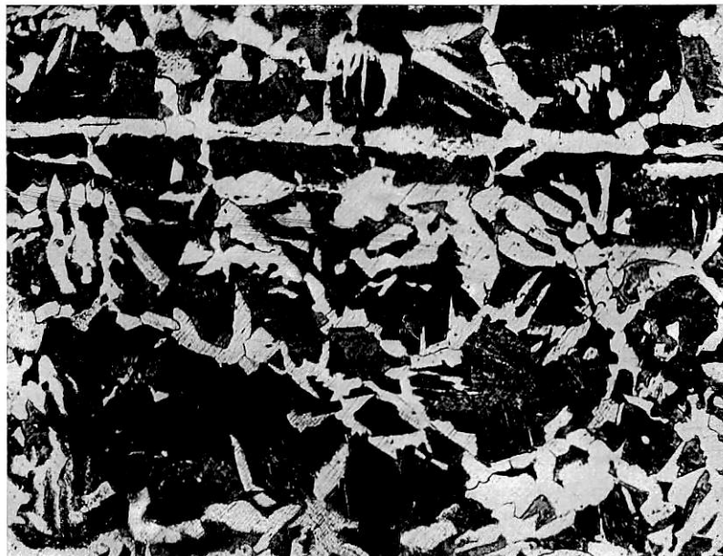
Abb. 31. Kleingefüge der Schiene, durch die Schweißung nicht beeinflusst. Ätzung II, \times 150 .
