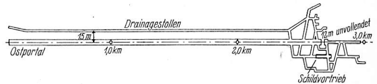
Abb. 14. Vortrieb auf der Ostseite des Tunnels.
