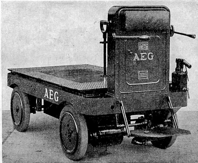
Abb. 1. Elektrokarren mit hydraulisch-mechanischer Hubvorrichtung.
