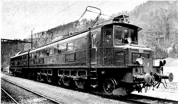
Abb. 4. 1 B 0 1 B 0 1 + 1 B 0 1 B 0 1 - Schnellzug- und Güterzuglokomotive Nr. 11801 der SBB. Stundenleistung 7500 PS.
