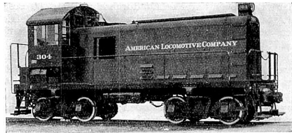
Abb. 1. Dieselelektrische Verschiebelokomotive für 300 PS Motorleistung.
