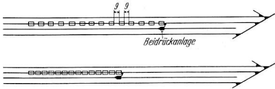
Abb. 5. Beidrücken mit besonderen Beidrückanlagen.
