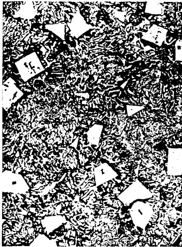
Abb. 28. Pb-Sb-Sn-Metall mit 75% Pb.
