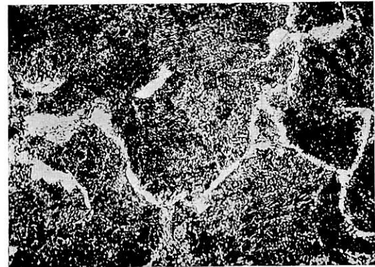
Abb. 3. Das Kleingefüge der härteren Bull Head-Schienen.
