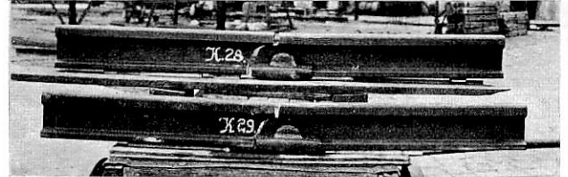
Abb. 23. Die geschweißten Schienenstöße (weichere Stahlschienen) nach der Schlagprobe.
