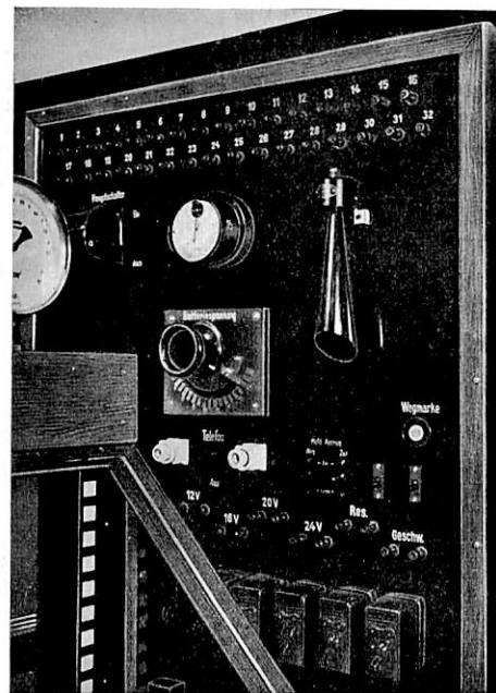
Abb. 2. Schalttafel 2 mit den verschiedenen Meßspannungen.
