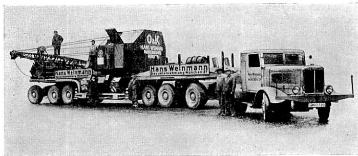
Meiller-Schwerlastanhänger, Type S 5 t 35 mit Schwingachsen und Rohrfahrgestell bis zu 40 t Nutzlast für Eiltransporte.
