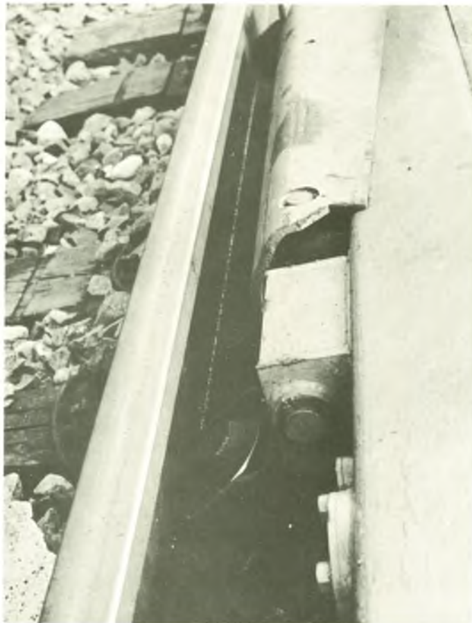
Trallan löper mot rälsfoten med speciella hjul.
