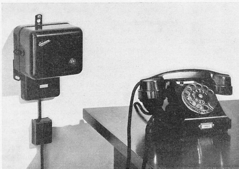
Fig. 12. Selektortillsats med telefonapparat för L.M. Ericssons selektorsystem.
