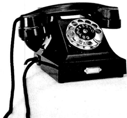
Fig. 21. Telefonapparat av L. M. Ericssons fabrikat. Apparater av denna typ anskaffades för den första automatiska abonnentväxeln vid Stockholm C. Typbeteckningen var då DE 704.
