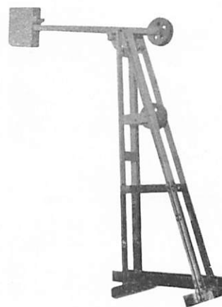
Bild 2. Enkelt växelspännverk typ XVI.
