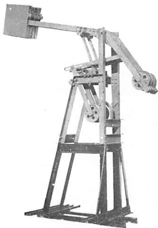
Bild 1. Dubbelt signalspännverk typ II.
