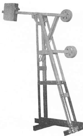
Bild 1. Enkelt signalspännverk typ XI.
